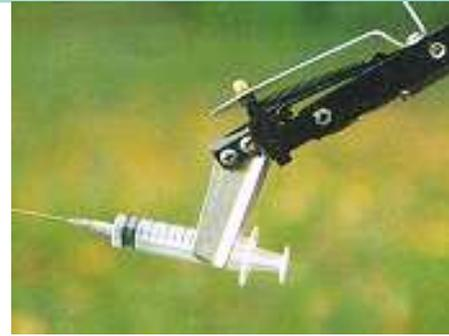
Il sistema previsto di raccolta, tramite pinze, evita ogni tipo di contatto tra tale materiale potenzialmente infetto e l'operatore.
